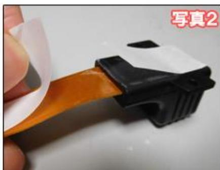
既に貼ってある両面テープのカバー側をすべて剥がしてください。粘着面には手で触れないようにしてください。
