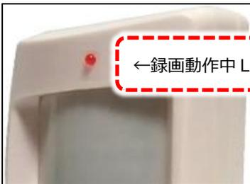
microSDが挿入されていた場合、されていない場合でも電源投入時に「録画動作中LED」が一瞬点灯します。これで電源が正常に入力されているかどうかを確認出来ます。
