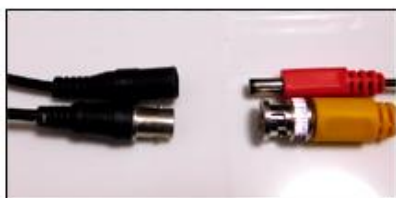
▲ カメラ・一体型ケーブル 接続前
