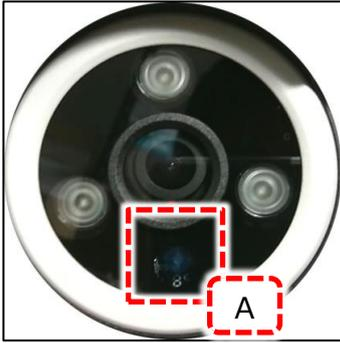
[A]部の赤外線LEDセンサー部（直径5mm前後の緑色の円型の部品）が床面側にある場合、本機の映像は正方向になります。
