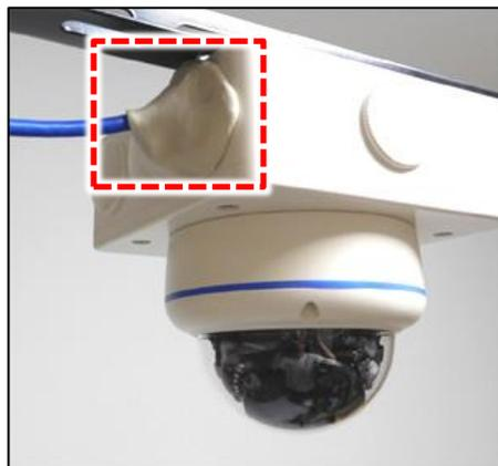
外からの入線の場合は、ボックスフタを手で開けてそこから入線します。入線の隙間はパテで必ず塞ぎます。電気工事業者様による施工の場合はPF管敷設による施工がより安全です。
