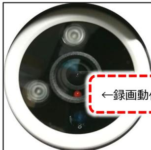
microSDが挿入されていた場合、されていない場合でも電源投入時に「録画動作中LED」が一瞬点灯します。これで電源が正常に入力されているかどうかを確認出来ます。
