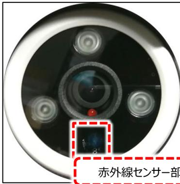
左写真のガラス面を両手で完全に覆うと、下記写真のように3つの赤外線LEDが点灯します。
