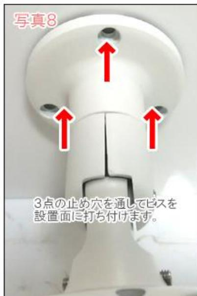
写真8のように、本機を天井面・壁面に付けながら3点をビスなどで止めます。
