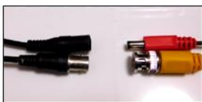
▲ カメラ・一体型ケーブル 接続前
