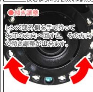
ドームカメラカバーを外した状態で調整します。
